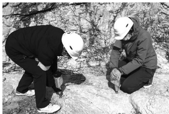
図 1 シュミット式ハンマー試験の実施状況
