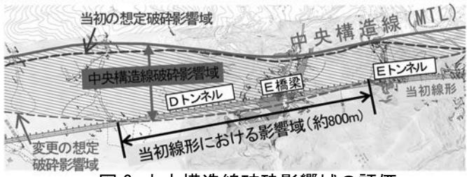
図 3 中央構造線破碎影響域の評価
