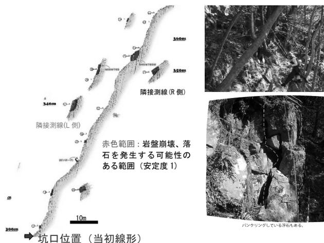
図6 坑口斜面上の不安定岩塊(クライミング調査)
