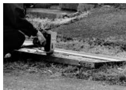
図 6 ハンドヘルド XRF の測定状況
