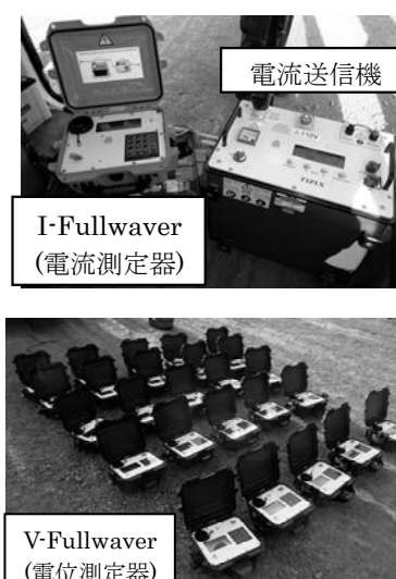
図 9 三次元電気探査測定装置
