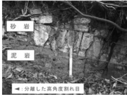
図-5 基盤岩に発達する高角度割れ目
