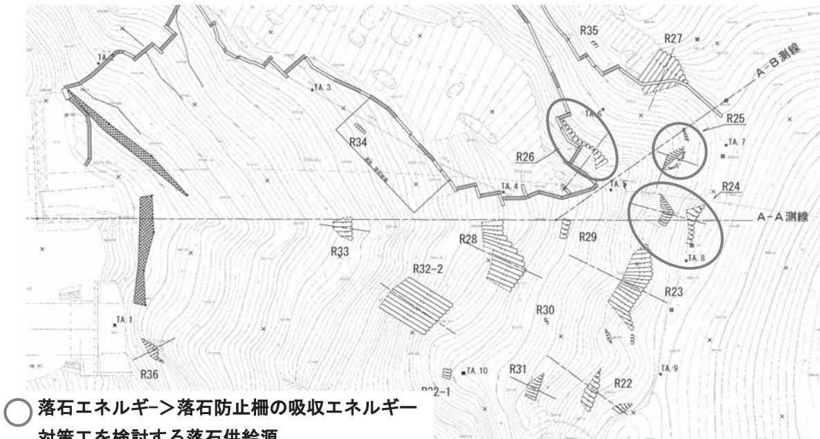
図 6 落石シミュレーション結果
