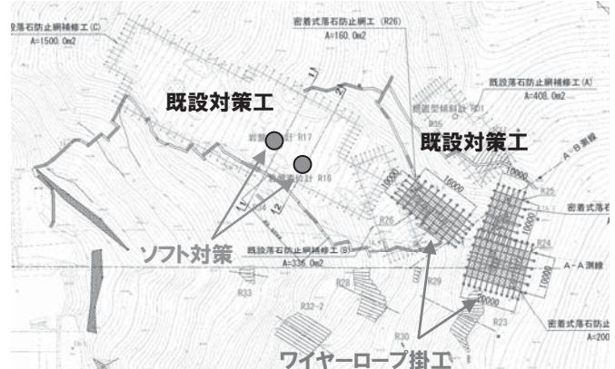
図4 落石対策工平面図
