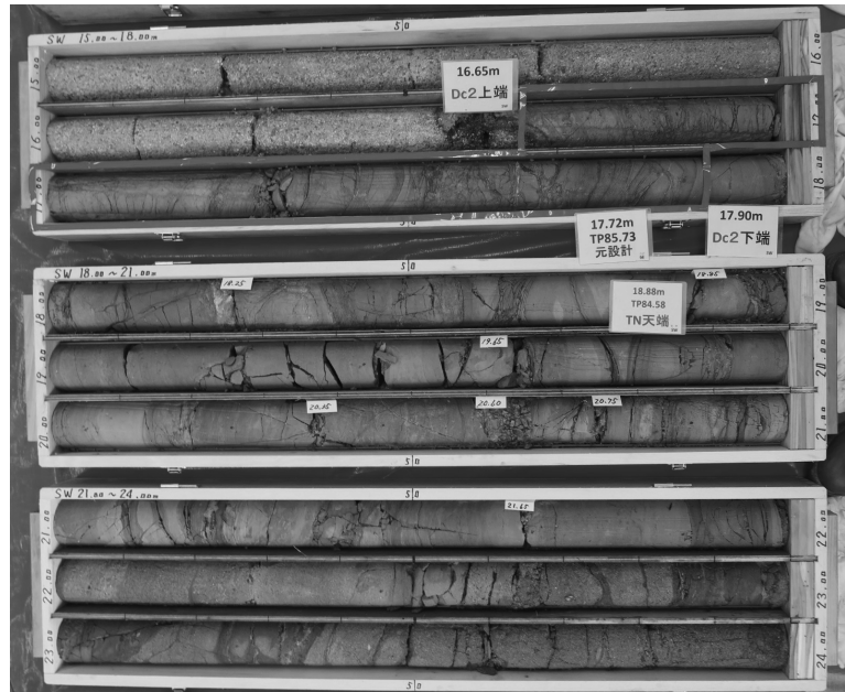
写真-1 博多駅前の陥没事故現場のボーリングコアの例（陥没部の南西、事故後の追加調査孔、深さ15～24m、佐々木撮影。同一コアの全体写真は文献3）で公開）
