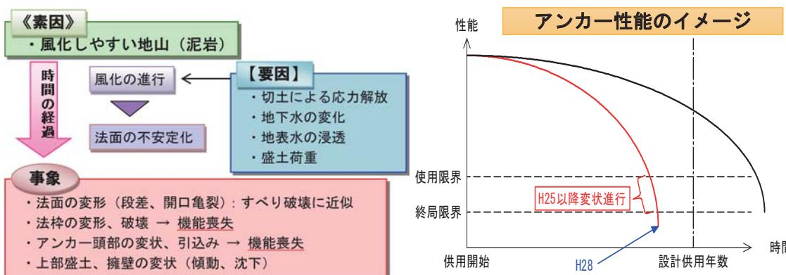
図8 変状原因とアンカーの機能喪失の模式図
