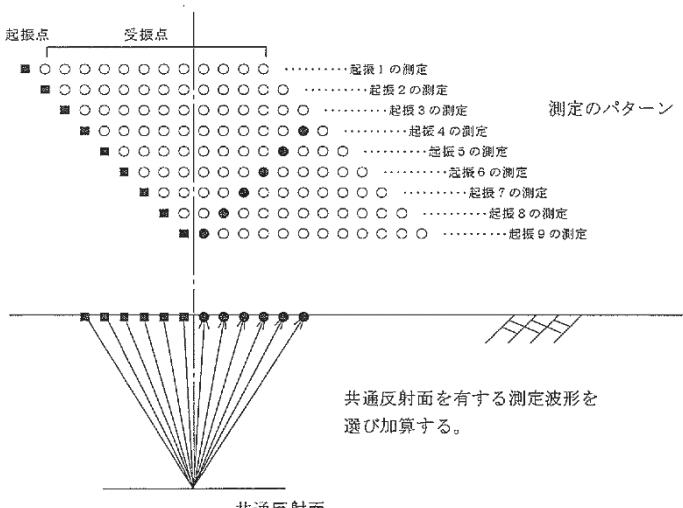
図 2 浅層反射法による弾性波探査概念図
