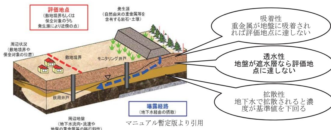
図3 サイト概念モデルの概念図
