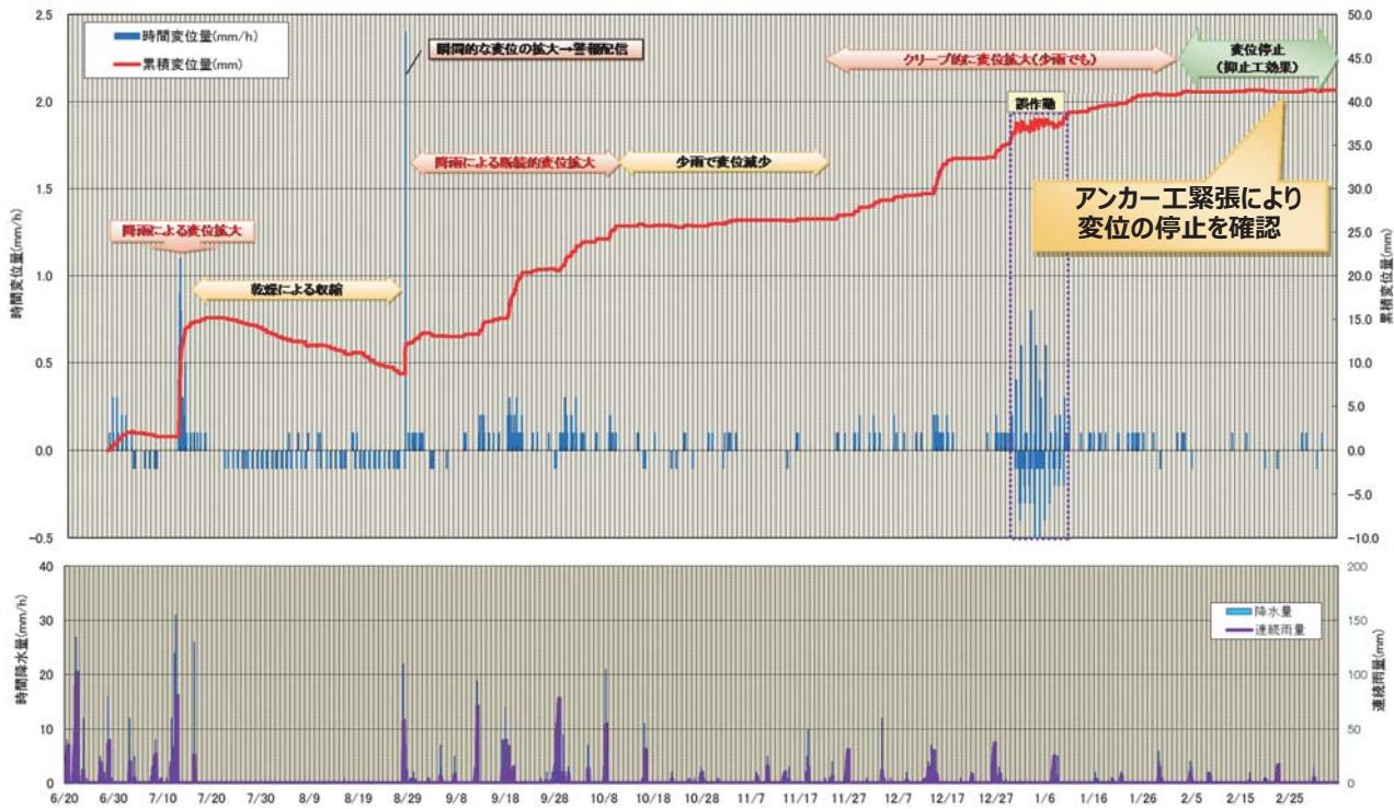
図10 地表面伸縮計経時変化(上段)と降水量図(下段)
