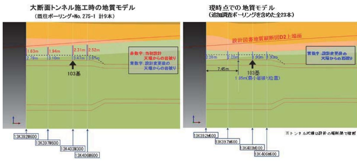
図-1 博多駅前の陥没事故現場の地質モデル（縦断面図）<sup>3)</sup>
