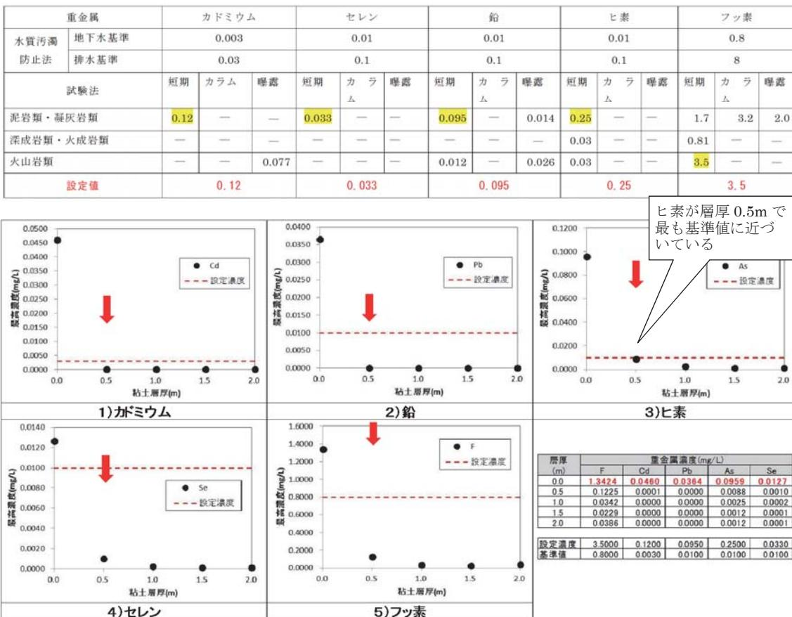
図7 基礎地盤が粘性土地盤の解析結果
