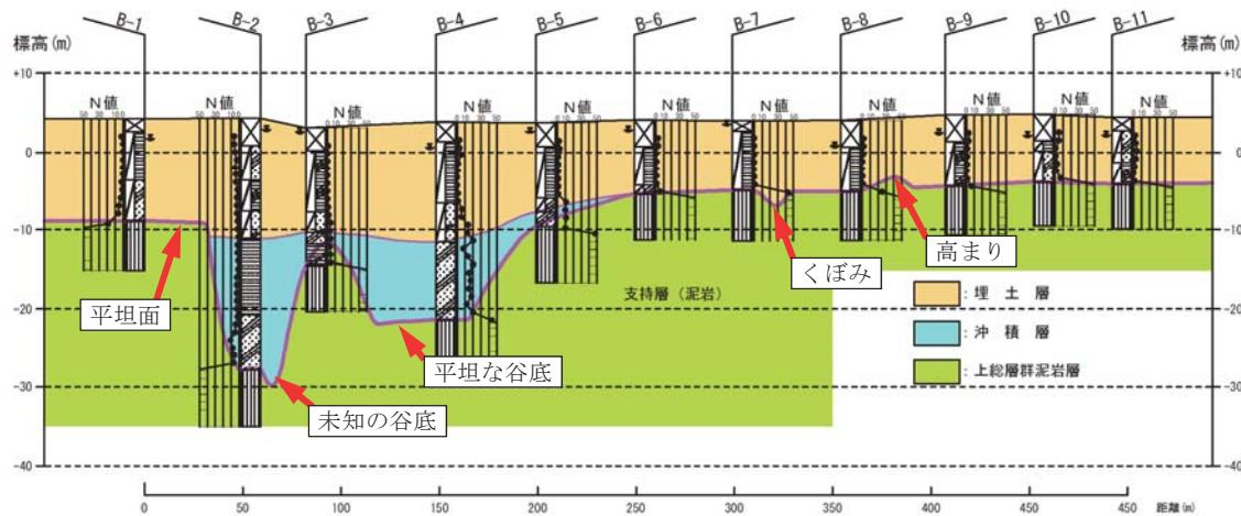
図6 浅層反射法弹性波探査結果を反映した想定地層断面図
