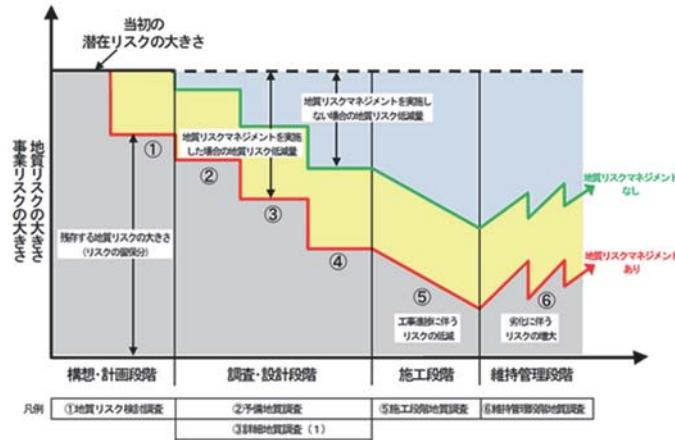
図-1 地質リスク低減の考え方
