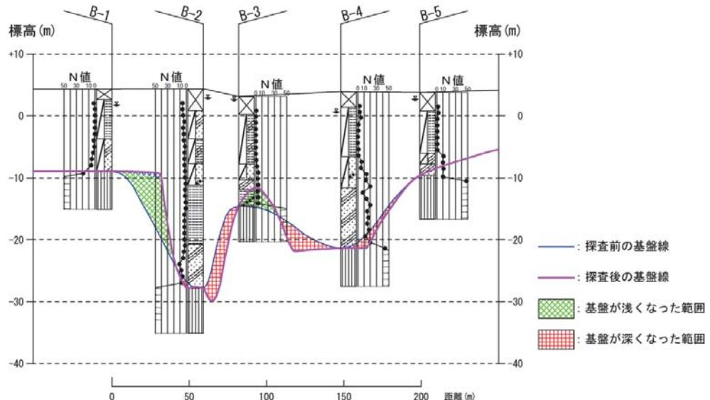
図7 浅層反射法弹性波探査実施前後の基盤出現深度の対比
