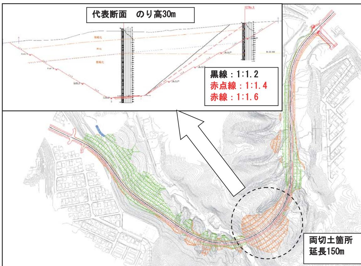
図1 対象箇所平面図・代表断面図(non-scale)
