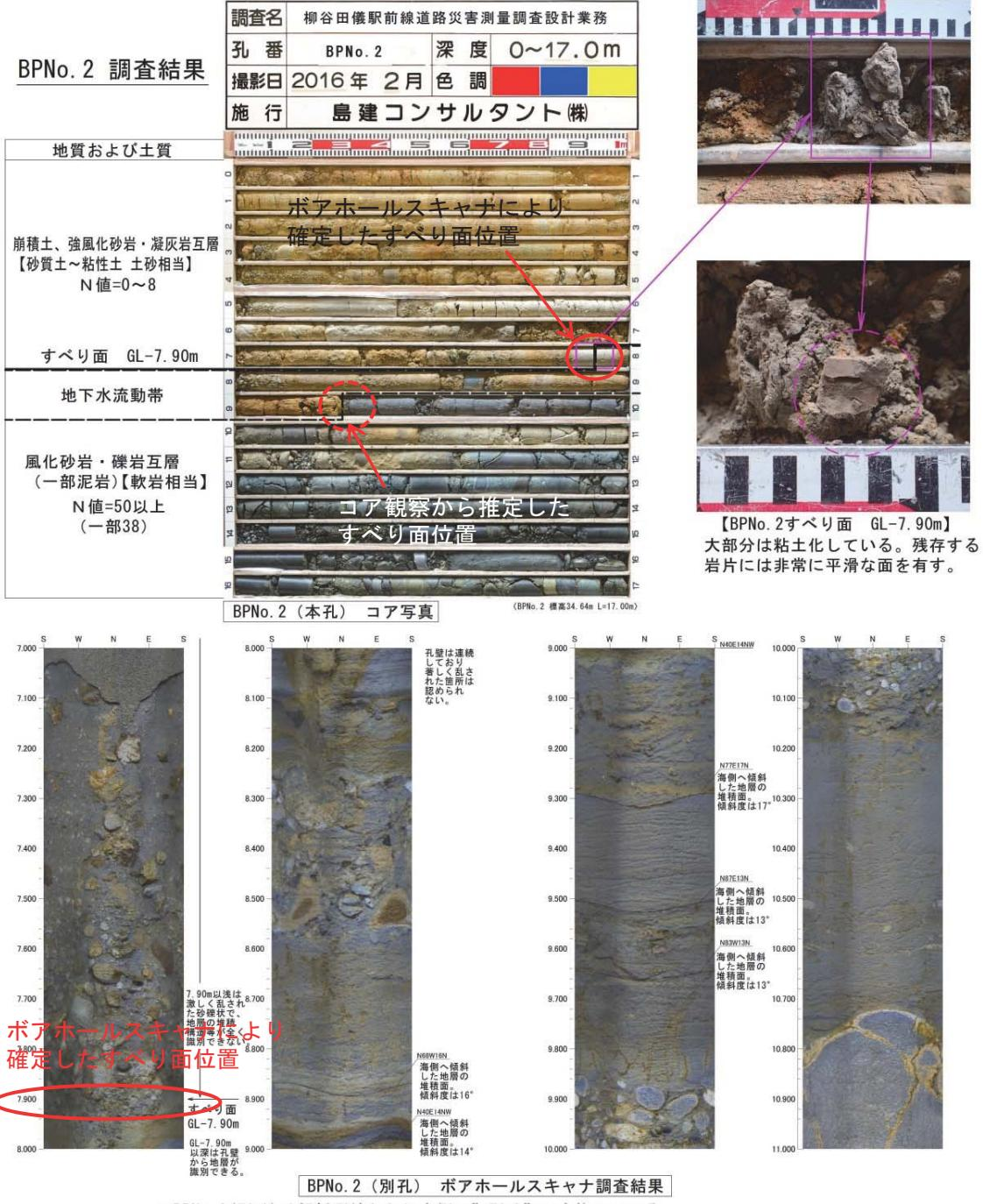
図2 ボーリングコア状況とボアホールスキャナ観測結果(BPNo. 2)
