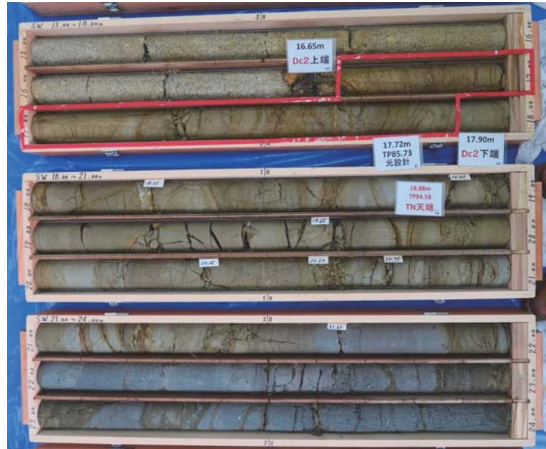
写真-1 博多駅前の陥没事故現場のボーリングコアの例
