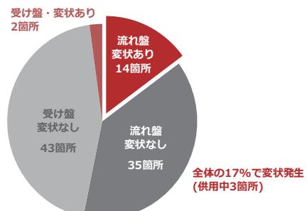
図3. 見かけ地質構造別変状箇所
