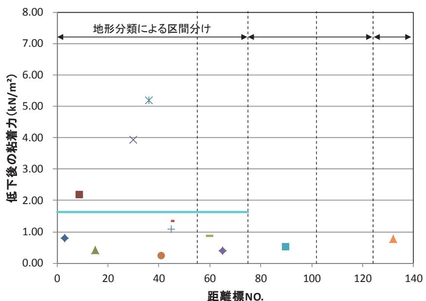
図3 強度低下後の粘着力分布図
