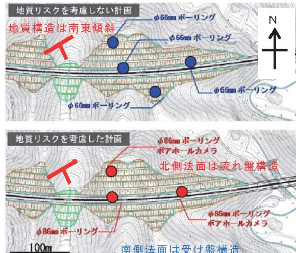
図7. 長大切土法面での後続調査計画例
