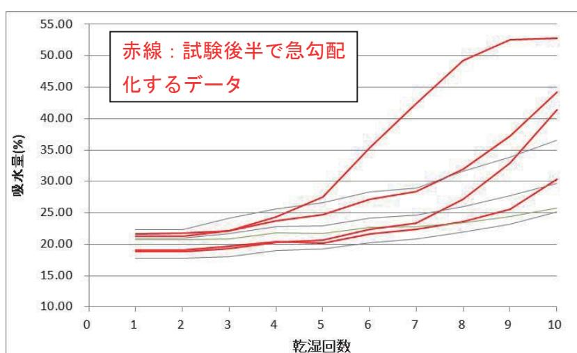
図2 吸水量変化図
