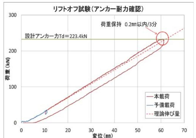
図4 リフトオフ試験(アンカーエ力確認)
