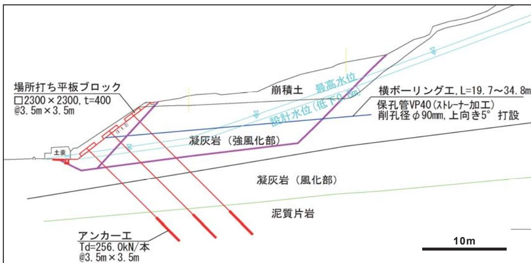
図5 対策工標準断面図
