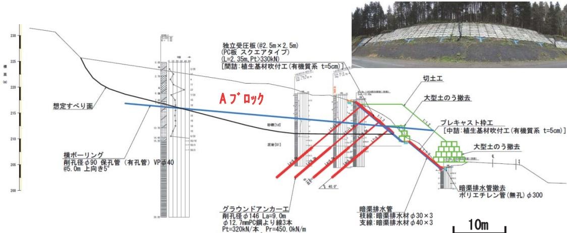
図 7 対策工施工標準断面図
