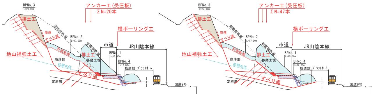
図3 すべり面① 対策工断面図
