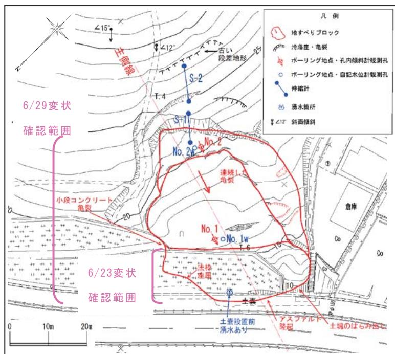
図1 地すべりブロック平面図
