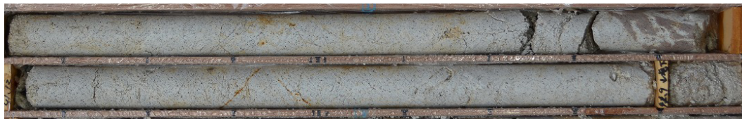
写真2 今回ボーリングによる新第三紀層火砕岩非変質帯のコア状況
