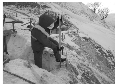
写真 6 メチレンブルー 凍結深度計(図 2 の M2 箇所)
