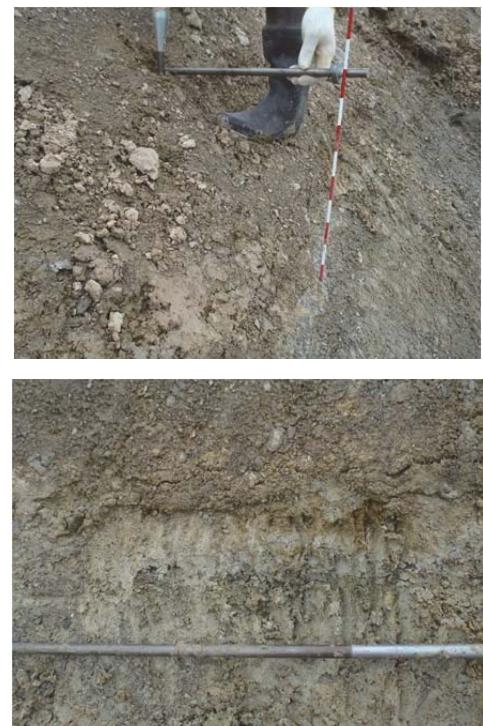
写真1 崩壊基底面の軟弱粘性土層
