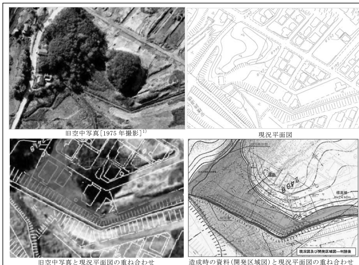
図-2 空中写真判読・地形判読による谷埋め盛土範囲の推定
