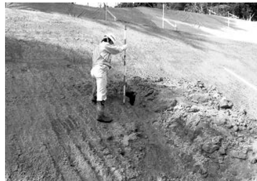
写真 2 前年度に確認された空洞
