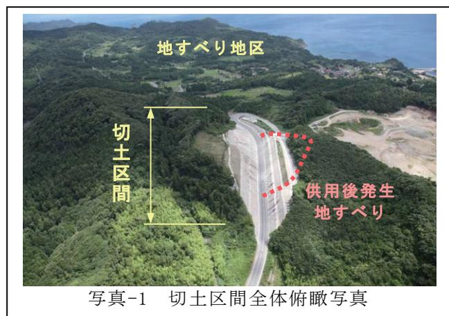
① 当初設計では切土勾配を土砂地山相当の1:1.0と設定し、植生法面保護工を計画していた。しかし、H15年の掘削着手段階でH=3m程度のパイロット掘削面が繰り返し崩壊を生じたため、施工を中断し追加調査と法面工再検討を実施した。ここで右側法面は、保全物件の関係で法勾配の変更が困難であったため、抑止工による対策を検討した。
