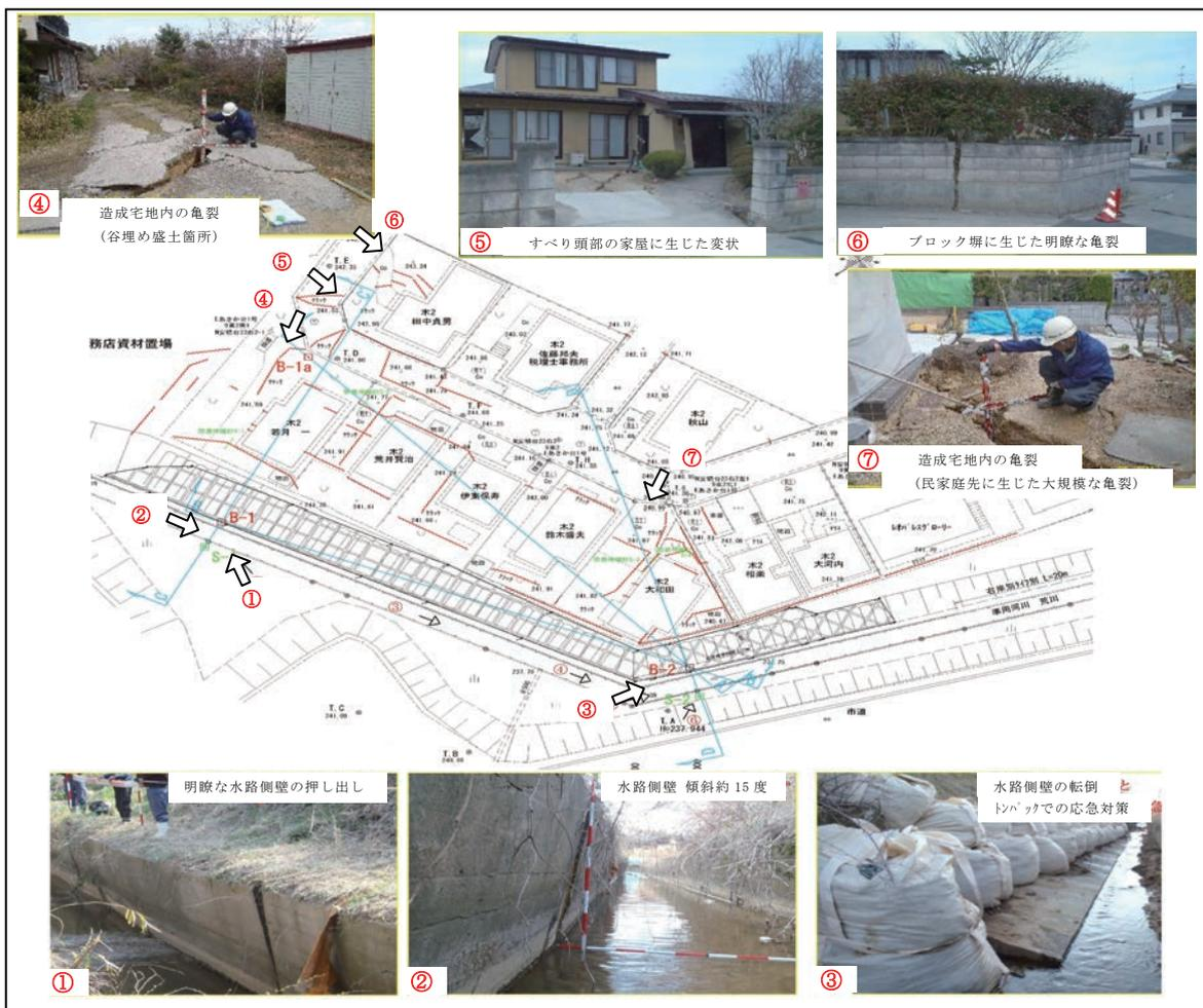
図-1 大型水路と住宅団地で発生した変状例
