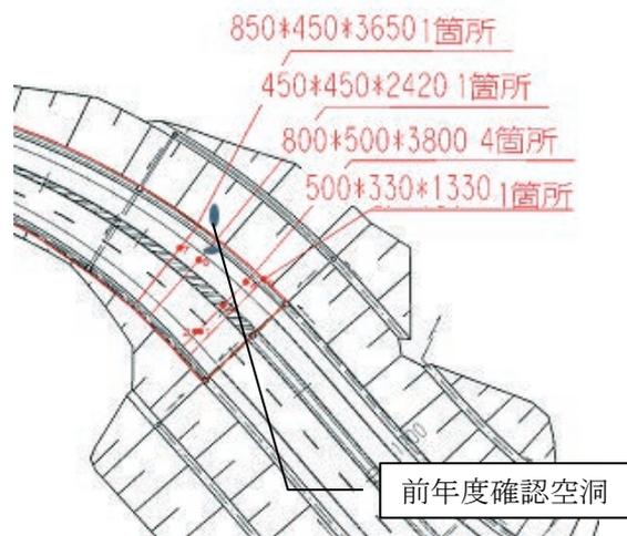
図 1 空洞確認箇所 (数字の単位は mm)
