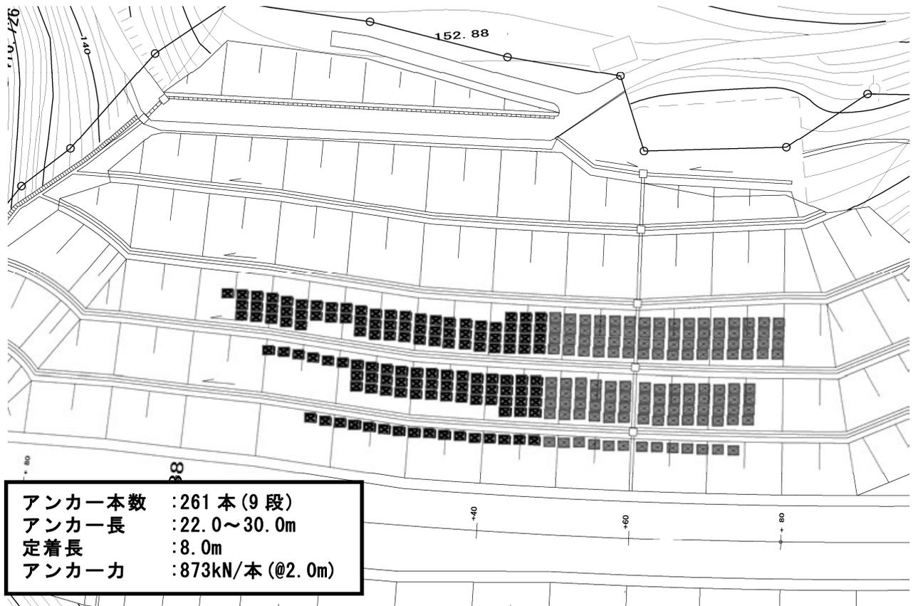
図 6 修正設計後の追加対策工平面図
