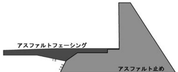
図-4 アスファルトフェーシング工の概念図
