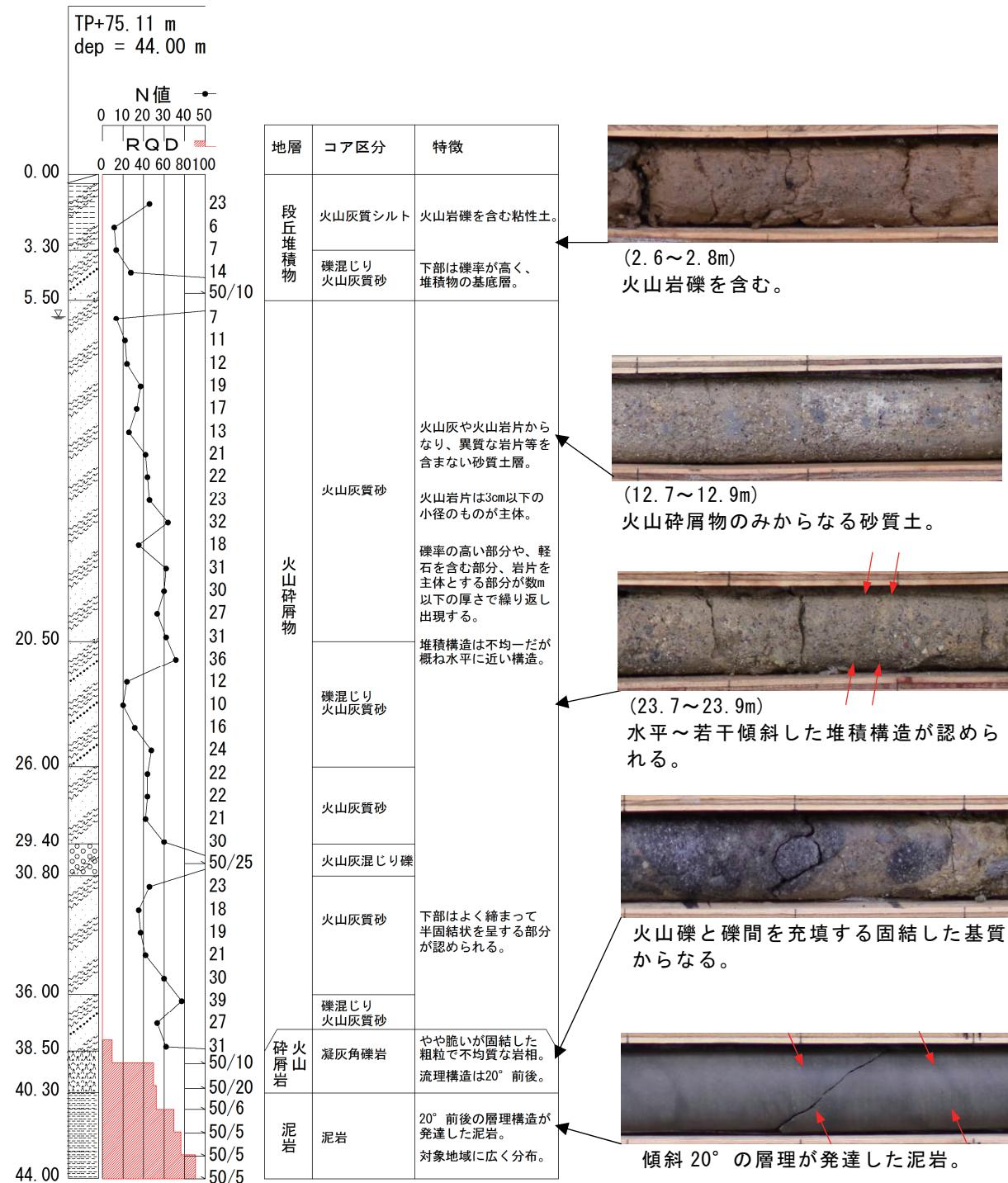
図 1 柱状図およびコア状況写真
