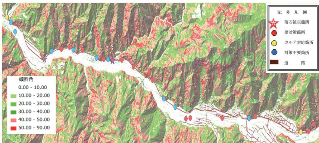
図 4 地形解析結果 ( $50^\circ$  以上の斜面) と防災点検結果 (落石危険箇所) の分布
