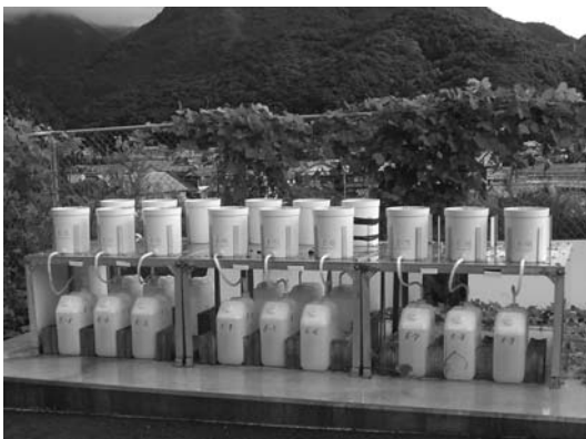
写真 1 曝露試験装置の設置状況
