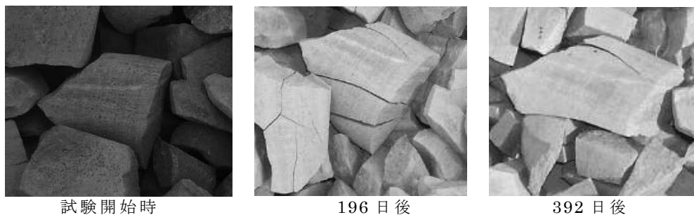
写真3 キレツにより細片化した試験試料の変化記録
