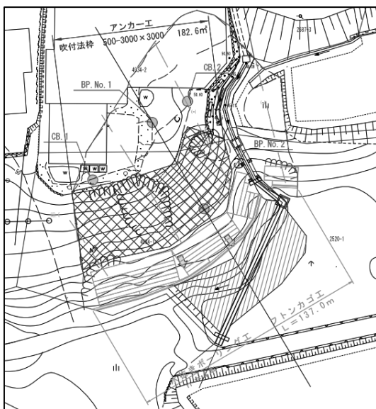
図1 対策工平面図
